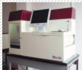
Отечественный лазерный стереолитограф. Рабочие моменты послойного создания биомodelей
