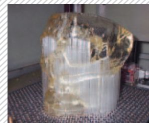
Отечественный лазерный стереолитограф. Рабочие моменты послойного создания биомodelей
